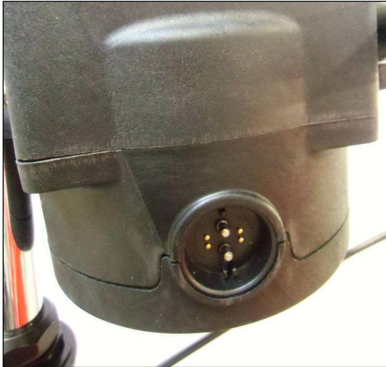
Per avviare la procedura di ricarica della batteria, va inserito il connettore proveniente dalla rastrelliera
