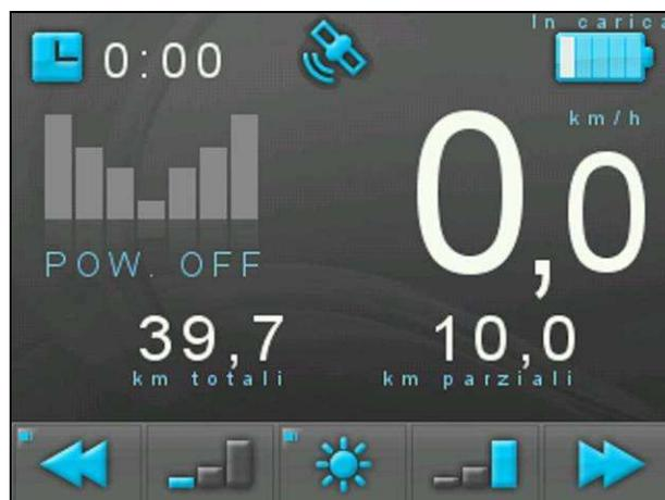
Al termine del processo di ricarica, l'indicazione "In carica" viene sostituita da "Carica terminata" e l'icona presenterà tutte le tacche accese.
