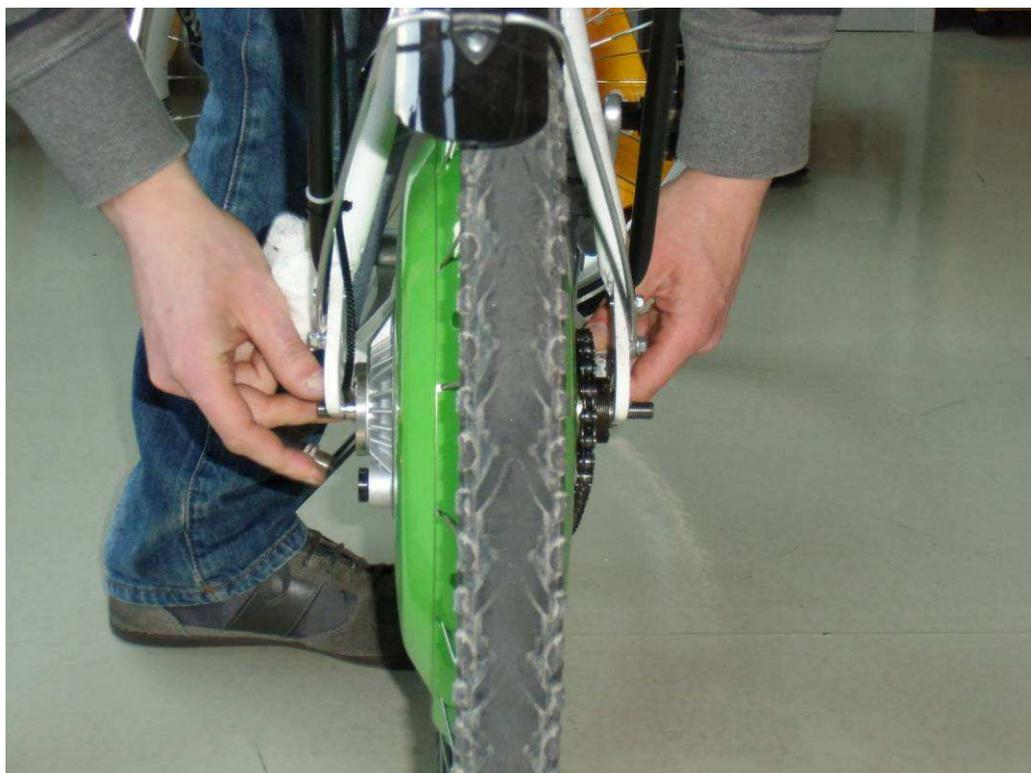
Inserire i perni ruota nel drop-out del telaio, **NON FINO IN FONDO.**
